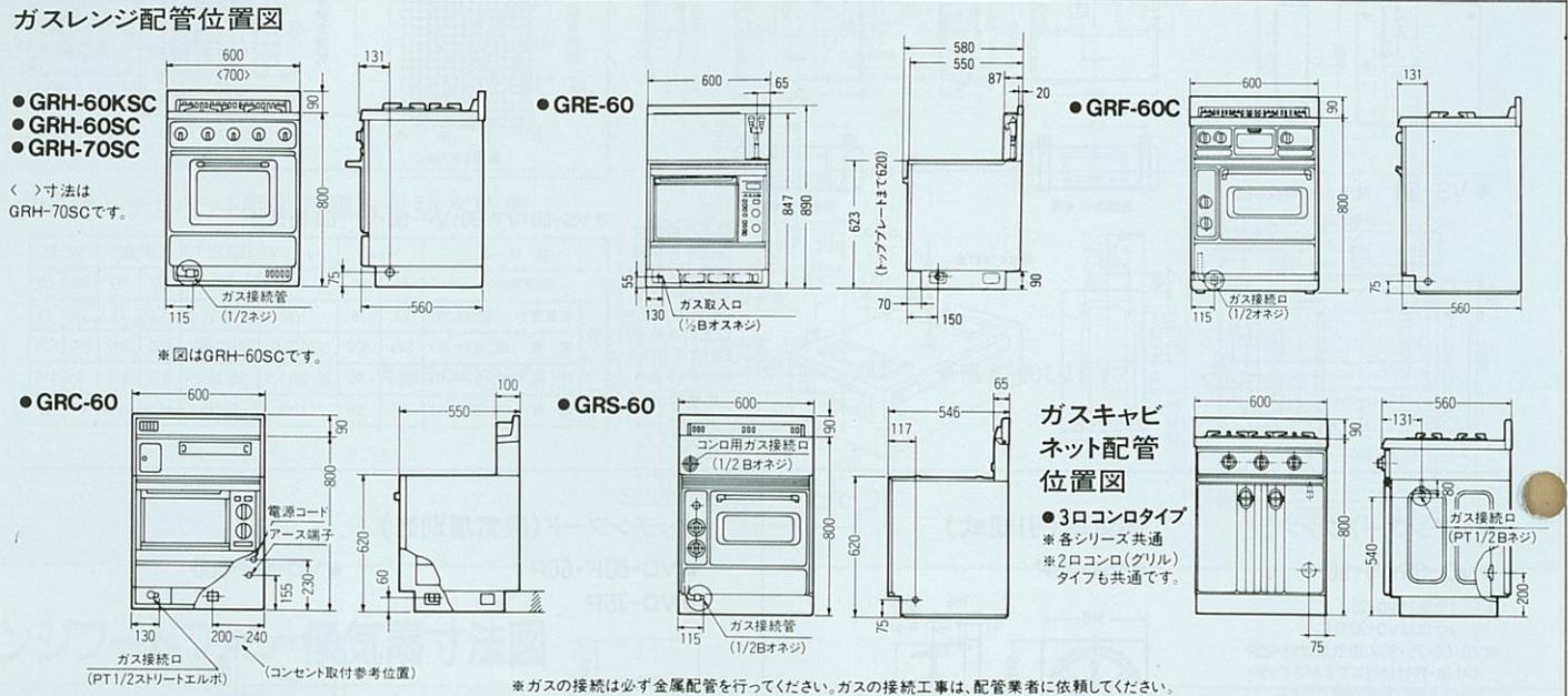
■ガスレンジ・ガスキャビネット・ガステーブル仕様・能力表(1時間当りのガス消費量) \*ガスレンジ・ガスキャビネットの接続は、金属配管15A(1/2B)鉄管/ガステーブルの接続は、9.5mmガス用ゴム管
