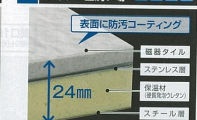
タフロア(ハイグレード) 表面は汚れが入り込む原因となる傷がつきにくい頑丈(タフ)な磁器タイル。厚み24mmの4層構造で長年の使用から来るたわみを防止します。
