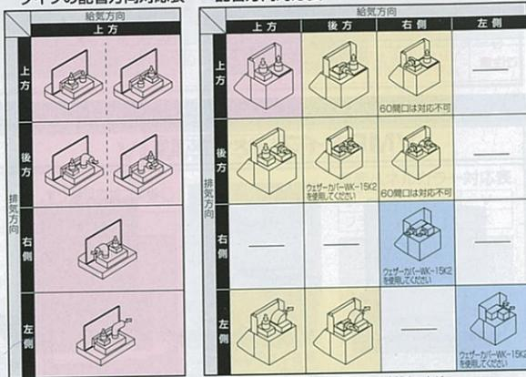
※給気方向は上方のみです。 ※給気と排気は位置は本体の取付方向によって左右を入れ替えることができます。
