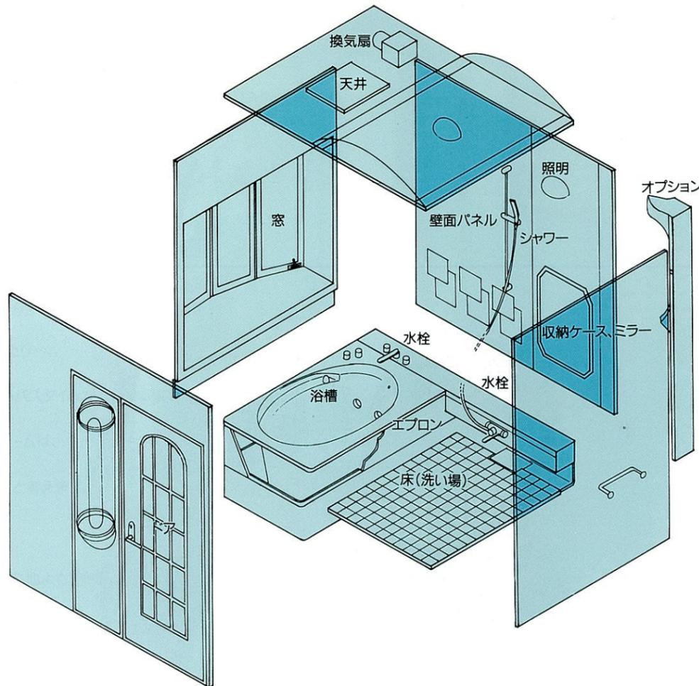
システムバスは壁、床、浴槽、天井などの部材で、ひとつの家のような空間をつくり出す独立工法を採用しています。各部材はあらかじめ工場で作成されているので、現場では組み立てるだけ。特にリフォーム時に適しています。また、壁、床、浴槽などの目に見える部材はもちろん、架台などの基本構造の充実を図り従来の浴室づくりで生じていた水漏れ、メジ割れ、お湯がすぐ冷める…などの問題点をすべてクリア。「きれいで長持ち」であることを大切に考えた設計です。
