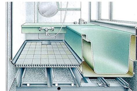
《ルシーナ》の洗い場の裏側には保温材を使用。浴槽側は、防水パンと浴槽の間に空気層を設け、室内の温かさを逃がしません。
