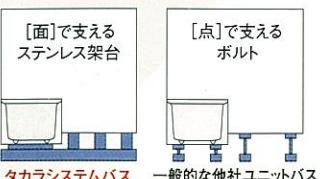
一般的なユニットバスは、何本かの細いボルト(しかもステンレスでない場合も多い)で浴室を支える方式を採用しています。
