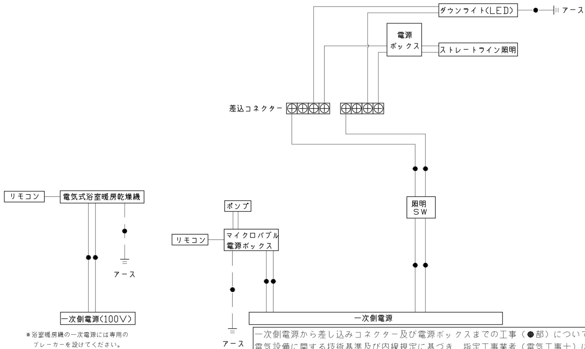
\*浴室暖房機の一次電源には専用のブレーカーを設けてください。
