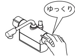
急に閉めると「ドン」という音がして配管に衝撃が加わり漏水で家財などを濡らす財産損害発生のおそれがあります。
