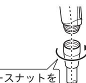
HEADのねじ部は樹脂製のため、斜めに取り付けるとねじがつぶれ、ホースに取り付けできなくなる場合があります。
