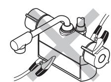
通電すると水栓が発熱し、破損して漏水で家財などを濡らす財産損害発生のおそれがあります。
