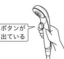
凍結が予想される際は、シャワー出止ボタンを出の状態にして、水栓金具の凍結予防の手順に従い水抜きをしてください。水抜きしないと凍結破損で漏水し、家財などを濡らす財産損害発生のおそれがあります。
