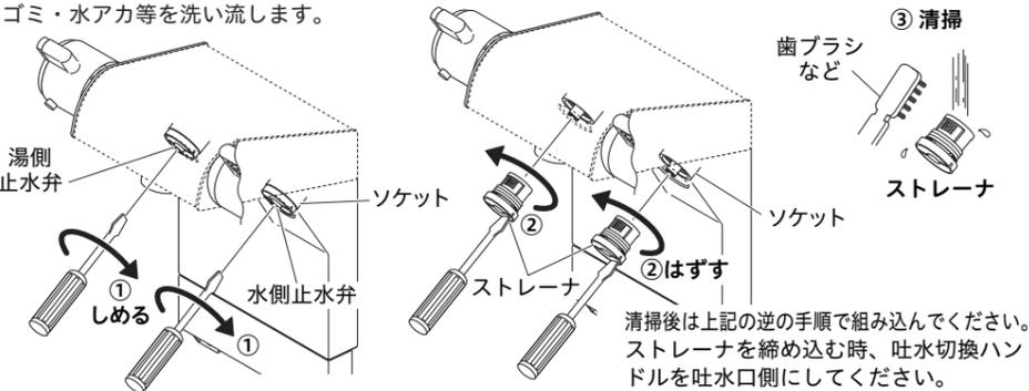
清掃後は上記の逆の手順で組み込んでください。ストレーナを締め込む時、吐水切換ハンドルを吐水口側にしてください。
