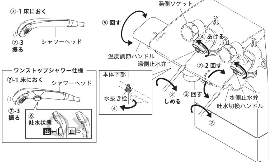
水抜き後 通水を再開する
