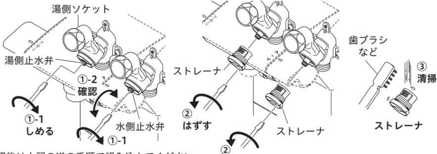
清掃後は上記の逆の手順で組み込んでください。ストレーナを締め込む時、吐水切換ハンドルを吐水口側にしてください。
