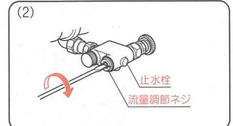
止水栓の流量調節ネジを⊖ドライバーで右にいっぱいまで回して締め込み、湯・水を完全に止めてください。
