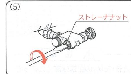
ストレーナをストレーナナットにはめ、止水栓にねじ込んでください。ねじ込む際、ストレーナナットが回らなくなるまで、確実にねじ込んでください。
