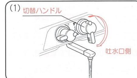
切替ハンドルのレバー部を下方方向に回し、吐水状態にしてください。
