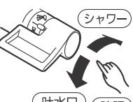
**!** 水抜部は水抜き以外の目的で開けないでください。
