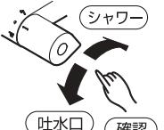
**禁止 やけど 水漏れ** 水抜部は水抜き以外の目的で開けないでください。
