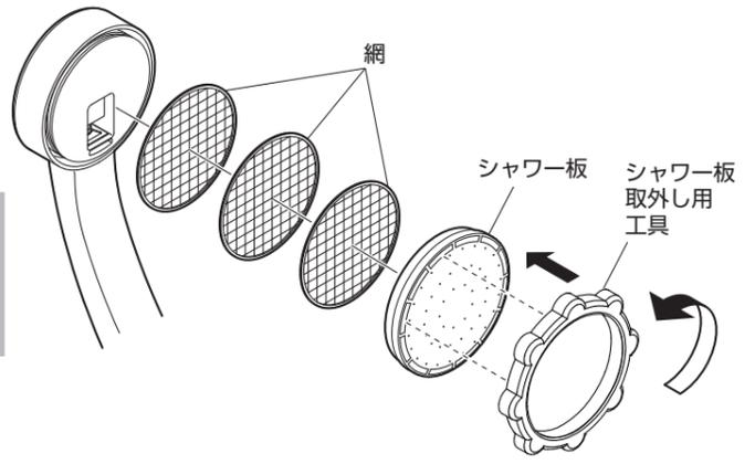
●ストレーナ・吐水口の汚れを放置しておく、十分な機能を発揮できないことがあります。快適・衛生的にお使いいただくために、日頃のお手入れをおすすめします。(近所で水道工事があつたり、長期間使用し湯水の出が悪くなった場合にも、汚れの点検・お手入れをおすすめします。)
