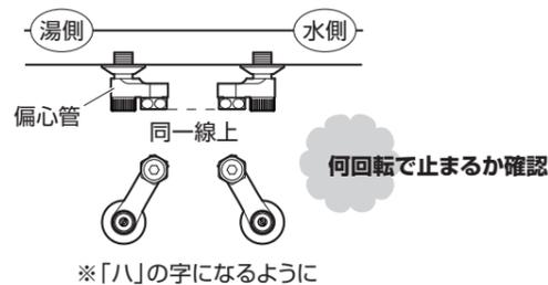
取付回転数は後で偏心管を仮固定する際の目安にします。
