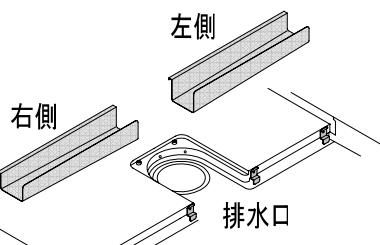
排水樋が排水口の両側にある場合は、排水樋の表示に従い取り付けます。
