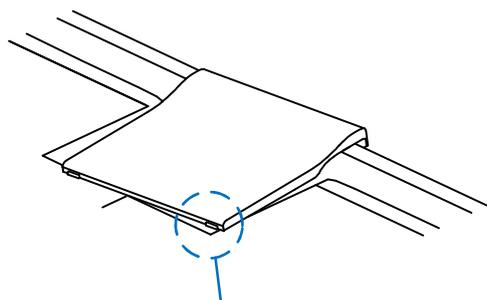
洗い場目皿が洗い場に乗り上げた状態で使用しないでください。洗い場が破損する恐れがあります。
