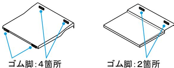
洗い場目皿のゴム脚取付用突起部にゴム脚を差し込む
