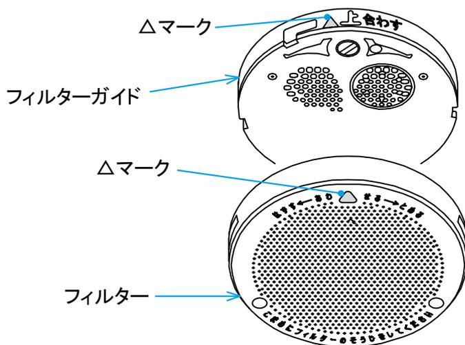
**ご注意** フィルターは必ず取り付けてご使用ください。フィルターを付けずに運転するとポンプ等の故障の原因となります。
