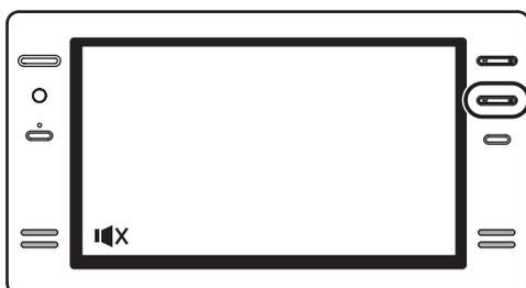
音量 **+** / **−** を押しても音が出ます。モニターの音量ボタン **−** **+** を押しても音が出ます。
