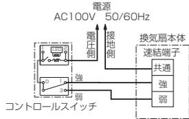
**お願い** ●結線間違いや異電圧印加などの誤結線を行いますとモーターが故障します。誤結線によるモーター故障の場合、サービス費用（交換部品代含む）はお客様のご負担となりますので結線図を十分確認の上、結線してください。
