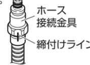
②クイックファスナーをシャワー側接続部とホース接続金具のツバ部に確実にはめ込んでください。次に抜け止めカバーをクイックファスナーに確実にはめ込んでください。
