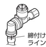
(2) クイックファスナーをシャワー側接続部とホース接続金具（寒冷地用は接続金具）の接続部（ツバ部）にカチッと音がするまで、確実にはめ込んでください。次に抜け止めカバーをクイックファスナーに確実にはめ込んでください。
