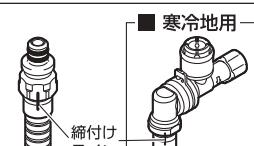
(2) クイックファスナーをシャワー側接続部とホース接続金具のツバ部に確実にはめ込んでください。次に抜け止めカバーをクイックファスナーに確実にはめ込んでください。
