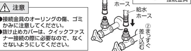
(2) クイックファスナーを給水・給湯ホースと接続金具のツバ部に確実ににはめ込んでください。次に抜け止めカバーをクイックファスナーに確実ににはめ込んでください。
