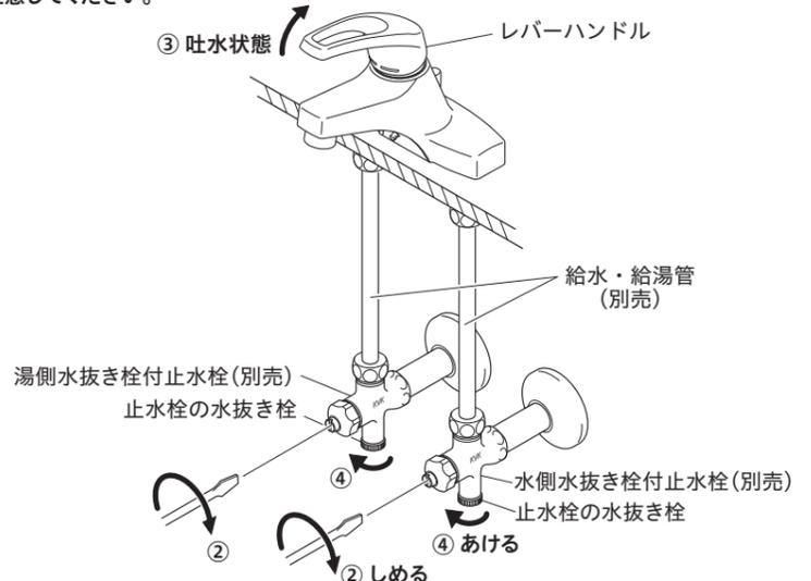
**水抜き後 通水を再開する**
