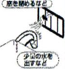
**禁** 凍結が予想される際は、配管と水栓の水抜き操作を同時に実施してください。
