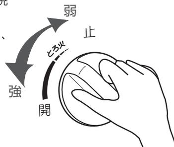
コンロ使用中にセンサー温度が高くなると、自動的に強火⇄弱火を繰り返し、鍋などの異常過熱を防止する機能が作動します。☞22ページ
