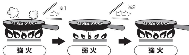
※1：最初に弱火になったとき、ブザーが“ピッ”と1回鳴ってお知らせします。鍋の温度が下がると再び強火(元の火力)に戻ります。
