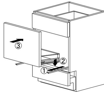
ソフトクローズレールはゆっくり自動的に閉まる機構が付いていますが、収納重量によってその動作は変化します。また、閉める力が強すぎると勢いよく閉ることがあり、弱すぎると途中で止まることがありますが、故障ではありません。収納重量に応じて適度な強さで閉めてください。
