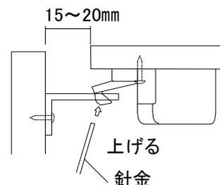
※強制解除後の耐震ラッチは必ず新しいものと交換する。
