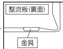
※整流板の金具は、はずさないでください。整流板の金具を掃除する際は、金具の端面に注意してください。
