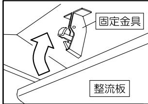
※整流板を閉めた後、確実に固定金具に掛かっているか、整流板の中央を片手で持ち、軽く下へ引張り、はずれないことを確認してください。
