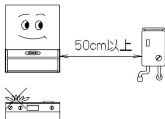
モーター焼損、排ガスによる塗装面のサビ発生の原因となります。
