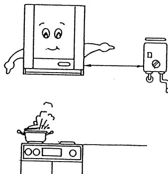
モータ焼損、排ガスによる塗装面のサビ発生の原因となります。
