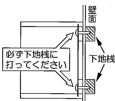
ネジ打ち部分に下地桟が無かったり、下地桿の強度が不足している場合や、短いネジ、細いネジを使用すると、レンジフード本体が脱落して大事故につながります。
