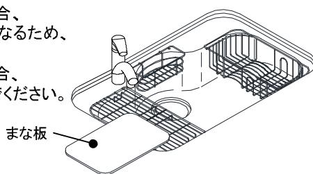
※水栓との組み合わせによっては干渉するケースがございます。その際は水栓と反対側に設置して下さい。
