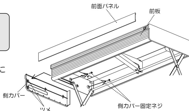
④前面パネルの両面テープの離型紙をはがし、前板にはみ出ないように貼り付けます。
