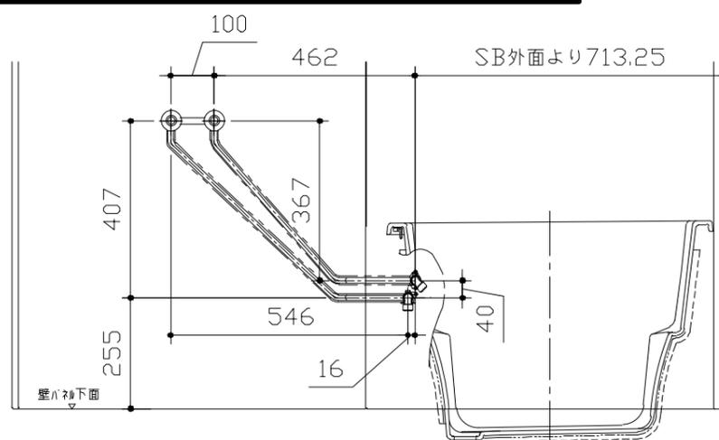
＜給水給湯管取合詳細図＞
