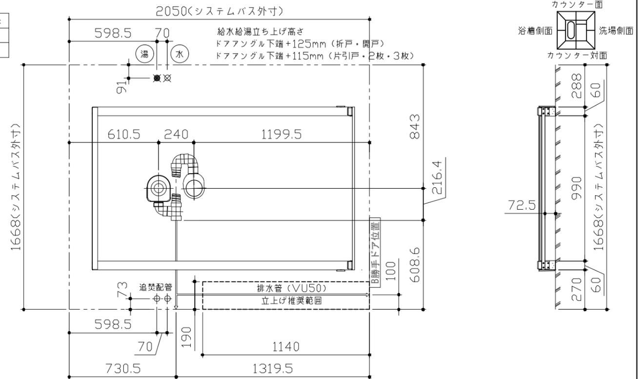
＜架台排水配管・給排水立上げ位置図＞
