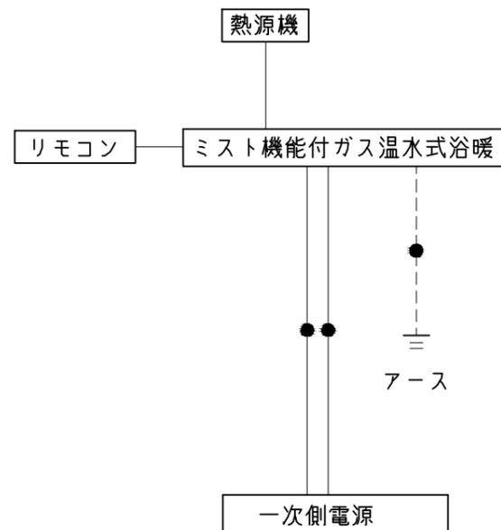
\*浴室暖房機の一次電源には専用のブレーカーを設けてください。
