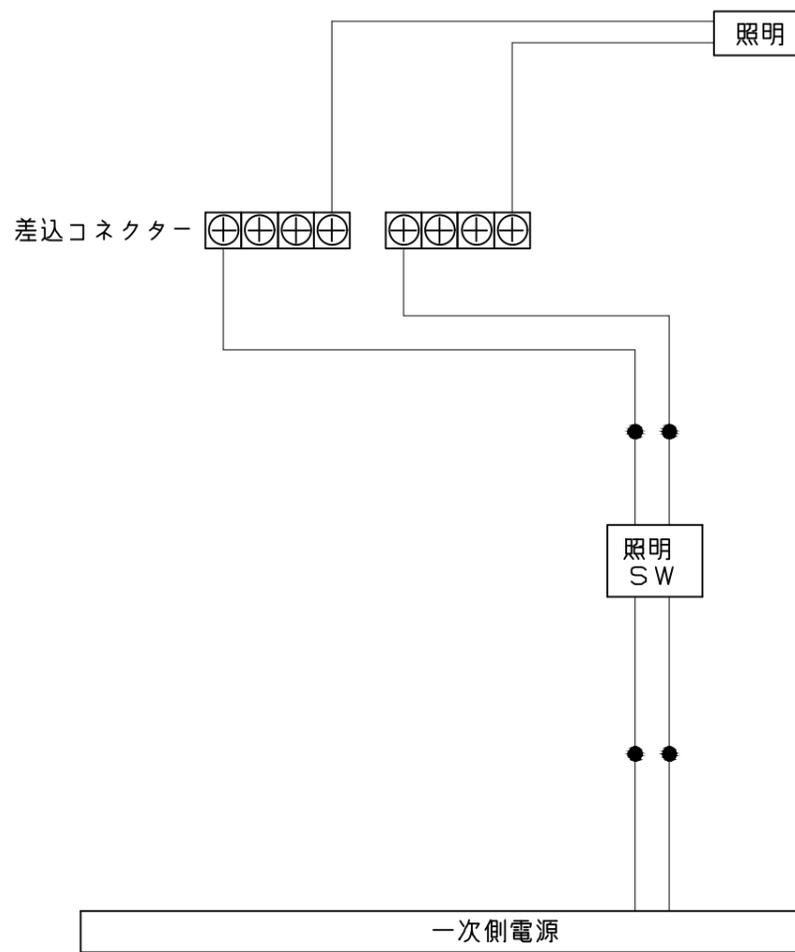
一次側電源から差し込みコネクター及び電源ボックスまでの工事（●部）については、電気設備に関する技術基準及び内線規定に基づき、指定工事業者（電気工事士）による施工が必要です。
