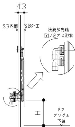
〈架台排水配管・給排水立上げ位置図〉
