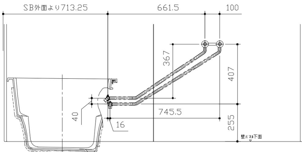
＜給水給湯管取合詳細図＞
