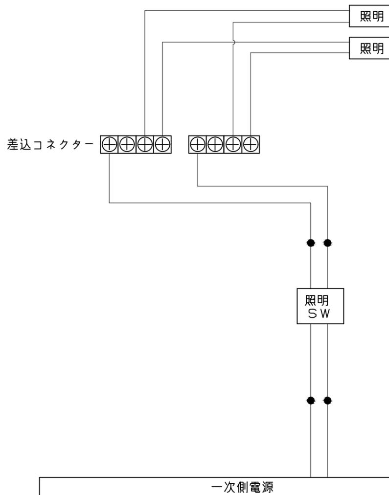
一次側電源から差し込みコネクター及び電源ボックスまでの工事（●部）については、電気設備に関する技術基準及び内線規定に基づき、指定工事業者（電気工事士）による施工が必要です。
