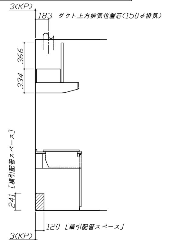
ZSシンク給水排水配管例図
