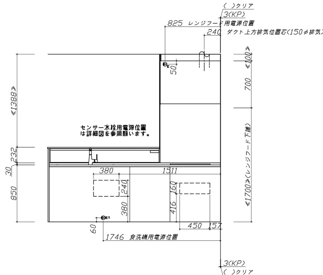
センサー水栓用電源位置は詳細図を参照願います。
