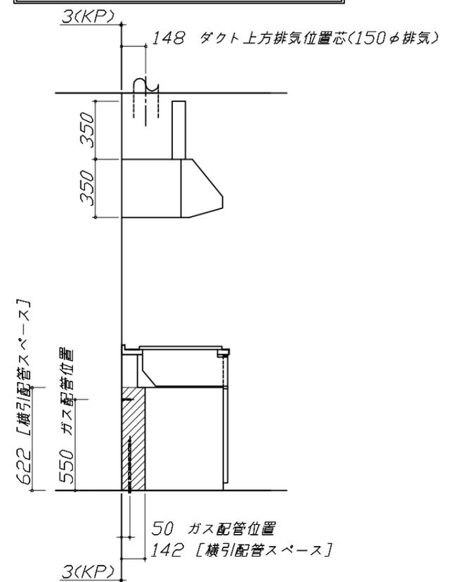
Zシンク給水排水配管例図
