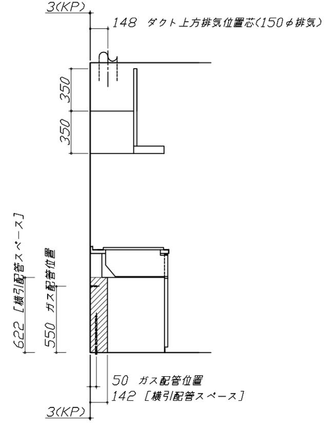
Zシンク給水排水配管例図
