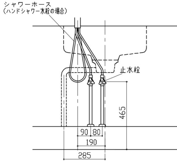
シンク下食器洗い乾燥機 配管例図
