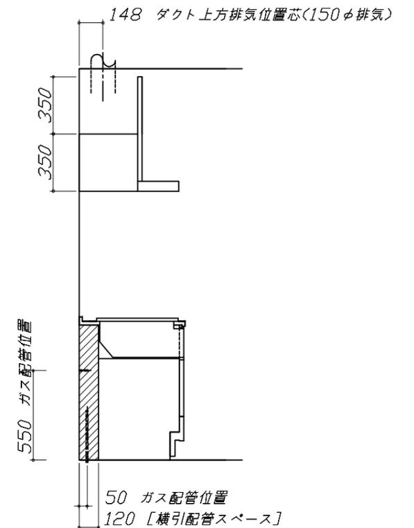
Zシンク給水排水配管例図
