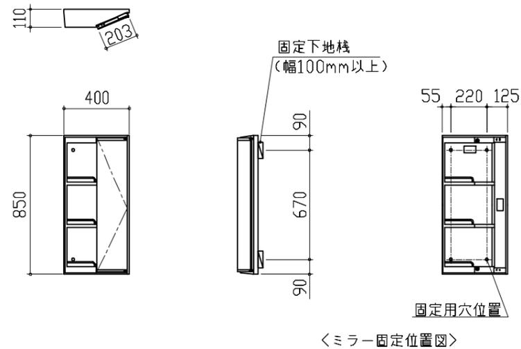
※キャビネット本体の上下を反転させて設置することで、左壁組付・右壁組付の両方に対応可能です。
