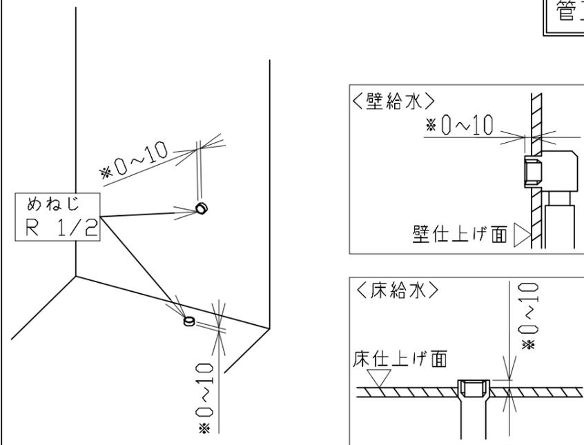
\*設備側給水管の取り出し出面は、床・壁仕上げ面から0~+10mm以内としてください。
