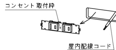
2. 屋内配線コードの先端の被覆をコンセント裏面のストリップゲージ(16mm)に合わせてむき、取付枠裏面の接続穴に直角に奥まで差し込んでください。
